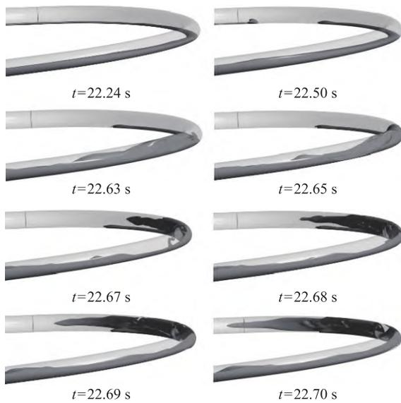
图 6 管段 A 的相分布云图
