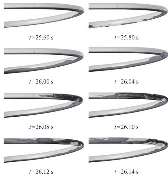
图 9 管段 B 的相分布云图
